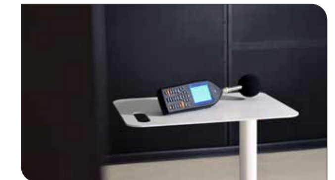
Komora akustyczna do badania głośności ruchu systemów przesuwanych.
