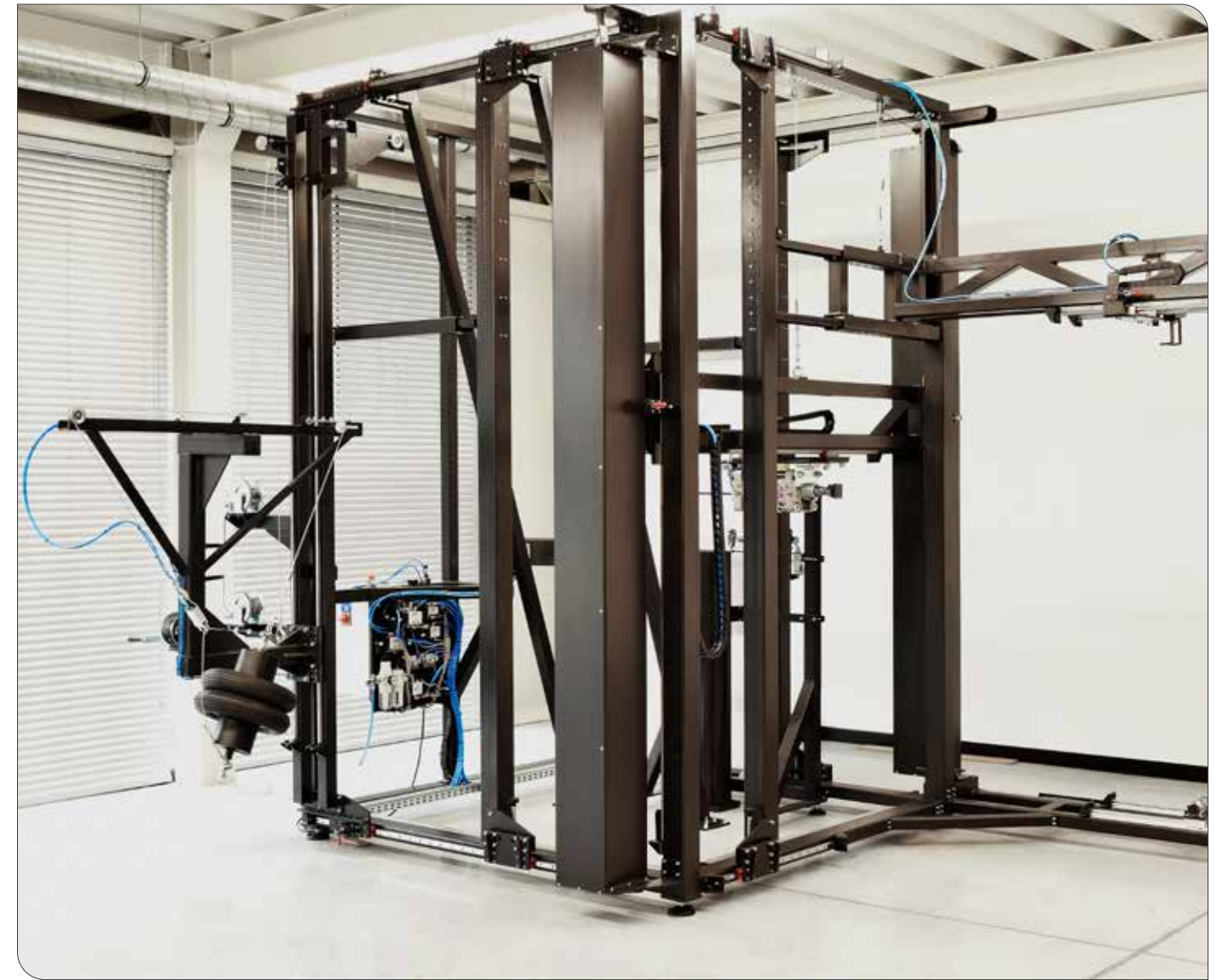
Maszyna do badania wytrzymałości drzwi na wielokrotne otwieranie i zamykanie, uderzenia ciałem miękkim i twardym, trzaskanie, siły wyłamujące i skręcające.
