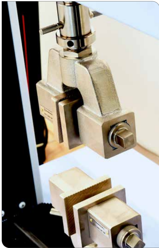
Maszyna wytrzymałościowa do zrywania i 3-punktowego łamania. Mierzy się na niej siły rozciągające oraz siły ściskające. Spektrometr służy do badania składu materiałów.
